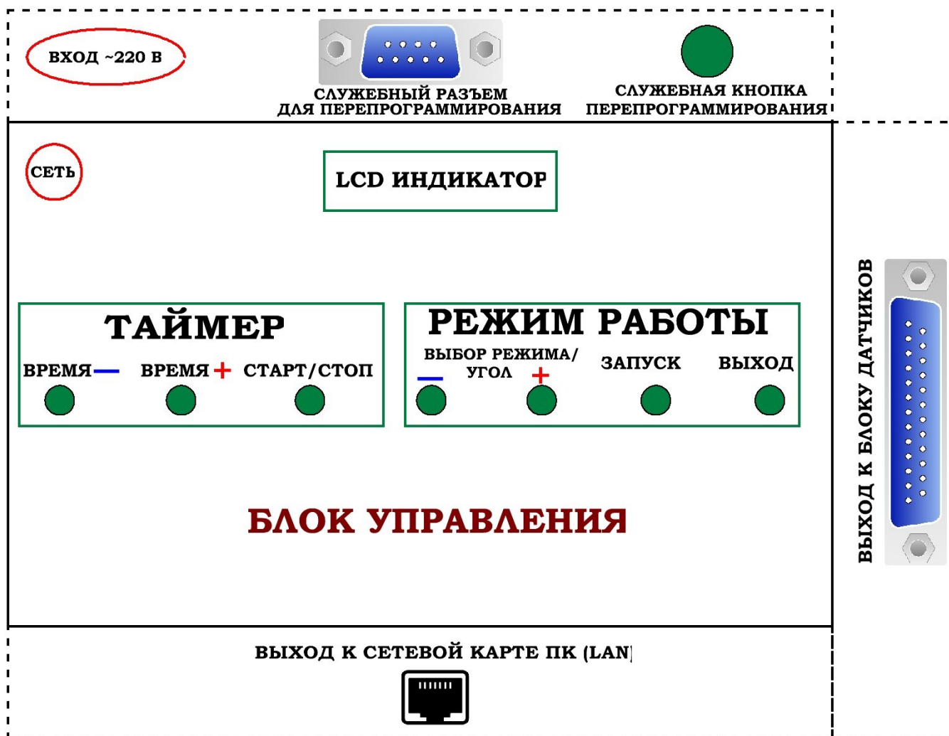
Рис. 5.2. Схема пульта управления экспериментальной установкой ФЯЛ-01.
