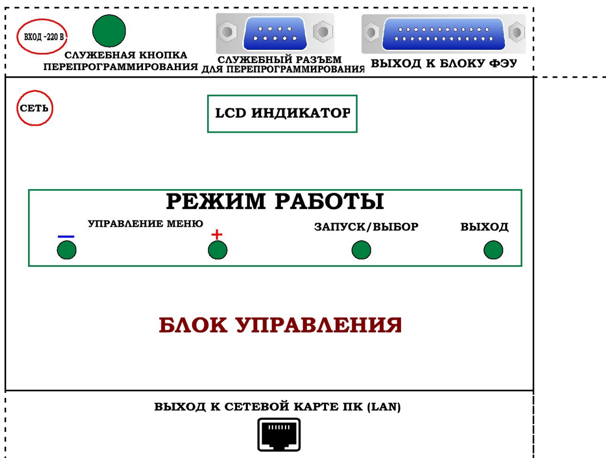
Рис. 3.2. Схема пульта управления экспериментальной установкой ФЯЛ-06.
