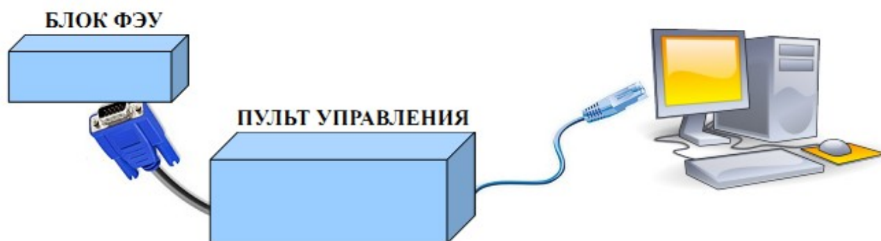
Рис 3.1. Блок-схема учебно-моделирующего комплекса ФЯЛ-06.
