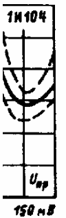
1И104 150 мВ Зона возможных положений зависимости шумовой проводимости от постоянного прямого напряжения.
