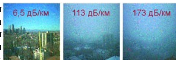
Рис. 13. Зависимость коэффициента затухания от погодных условий.
