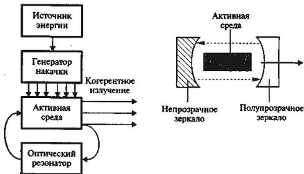
Рис. 13. Принцип устройства и структурная схема лазера.
