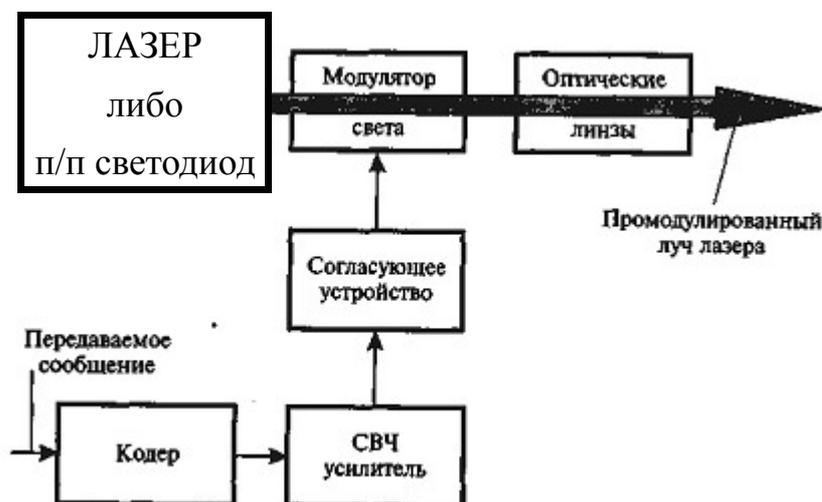
Рис. 14. Структурная схема оптического передатчика
