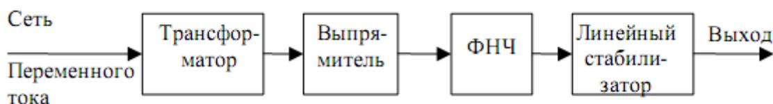
Рис. 1.1. Упрощенная функциональная схема линейного стабилизированного источника питания.
