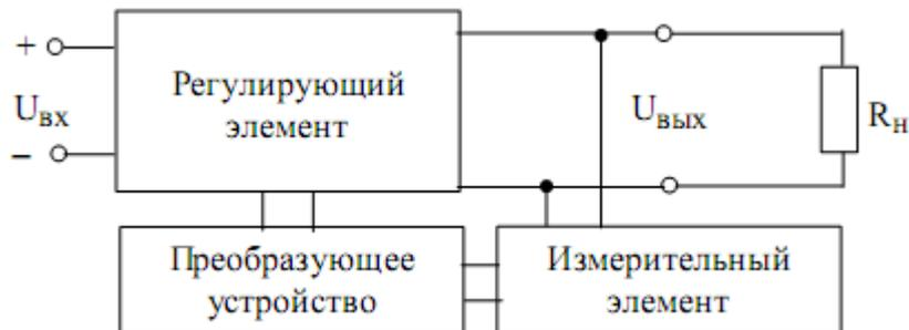
Рис. 1.4. Функциональная схема компенсационного стабилизатора.
