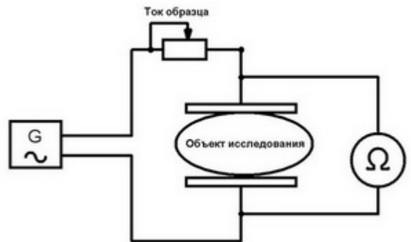
Рис. 19. Принципиальная блок-схема опыта для измерения импеданса биологического объекта.
