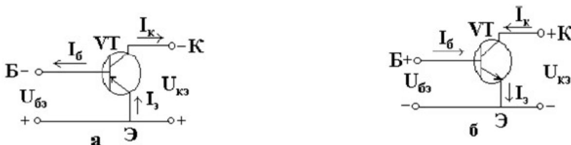
Рис. 2 Обозначение транзистора на электрических схемах а) р-п-р б)п-р-п
