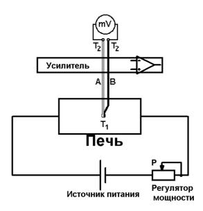
Рис. 6. Принципиальная упрощенная электрическая блок-схема учебной установки ФЭЛ-17 для наблюдения термоэлектрического эффекта.
