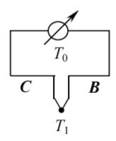
Рис. 5.Схема включения термопары.
