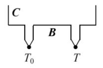
Рис. 4.Схема включения дифференциальной термопары
